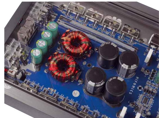
Die Spannungsversorgungen per Doppelnetzteil sind bei beiden Verstärkern gut für ein Kilowatt
