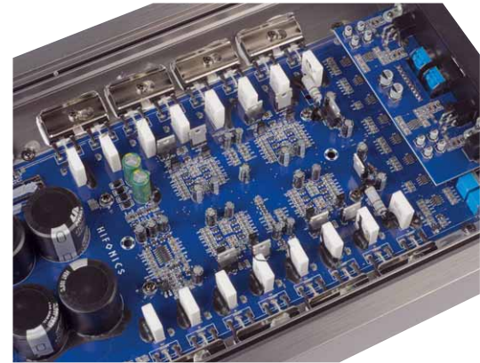
Diskret per SMD aufgebaute Class AB Stufen, hier 4 Stück bei der ZXE1000/4
