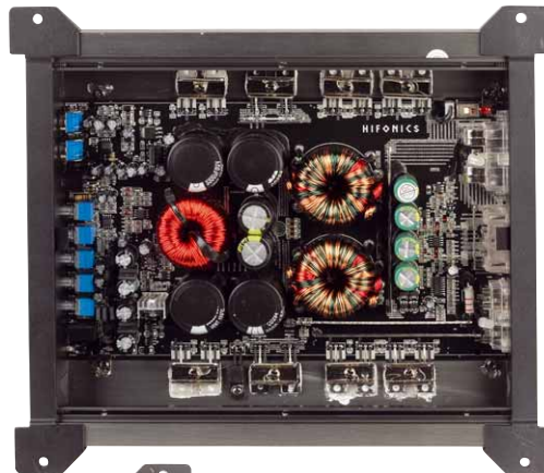
Die ZXE2000/1 hat alles an Bord. Bassboost, Tiefpass, Subsonic (und Phase) sorgen für universelle Einsetzbarkeit
