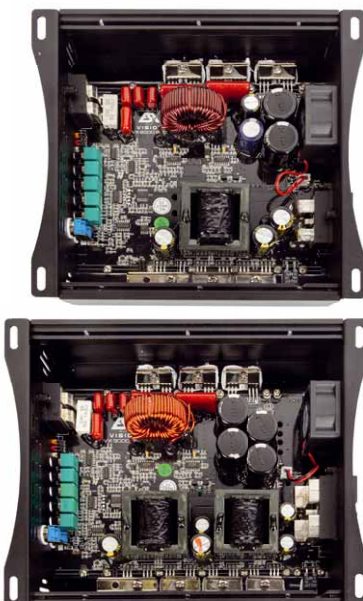
Im Gegensatz zur VX2000 PRO (oben) hat die VX3000 Pro zwei Netztrafos
