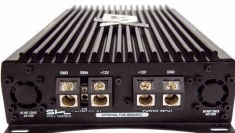
Doppelte Stromklemmen bei der VX8000 PRO (links), einfache bei den anderen (rechts).
