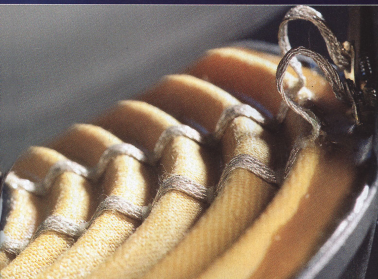
Penibel: Die flachen Zuführungslitzen schmiegen sich jeder Falte der Zentrierspinne an und sind in jeder Rille mit Garn fixiert – so verteilt sich die Kraft gleichmäßig.
