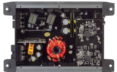
Verwandschaft: Links die 900/4 mit 4 kleineren Class-D Spulen, rechts die 600/2 mit zwei größeren Spulen
