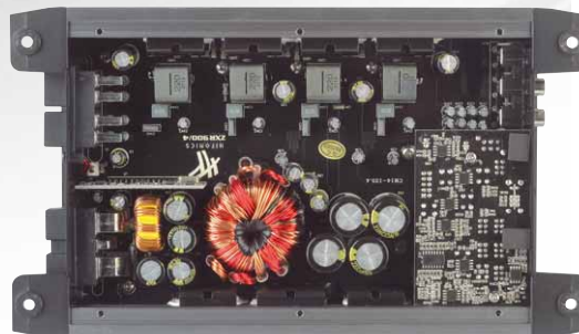
Verwandschaft: Links die 900/4 mit 4 kleineren Class-D Spulen, rechts die 600/2 mit zwei größeren Spulen
